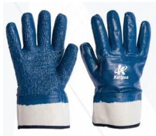
Luva de proteção, confeccionada em malha de Algodão, com a palma e face palmar interna reforçada em Grafatex. Possui revestimento total em borracha nitrílica: palma, dorso e parte do punho e possui acabamento antiderrapante rugoso, do mesmo material do banho, na palma e face palmar dos dedos. Punho em lona.
