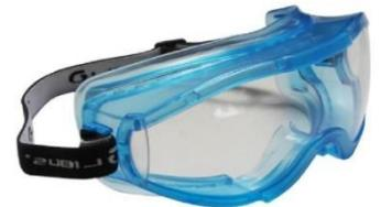
Desenhado para proteger os olhos contrabatidas, impactos de partículas volantes, pó e fagulhas. Visão panorâmica lente de policarbonato, filtro UV, armação com elastômero extraflexível para uma vedação perfeita e confortável no rosto. Correia elástica de 15 mm com fivela para ajuste. Possui sistema de ventilação indireta, composto de dez fendas na parte superior e oito na parte inferior.
